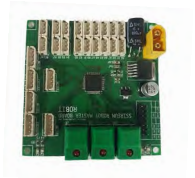
Fig. 6. Main Controller Module
